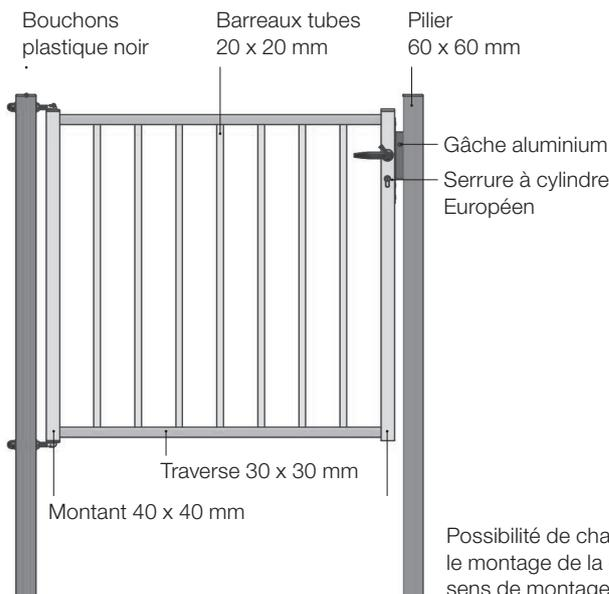
Possibilité de changer le sens d'ouverture en inversant le montage de la gâche sur le poteau et en inversant le sens de montage des plaques vissées sur le vantail.
