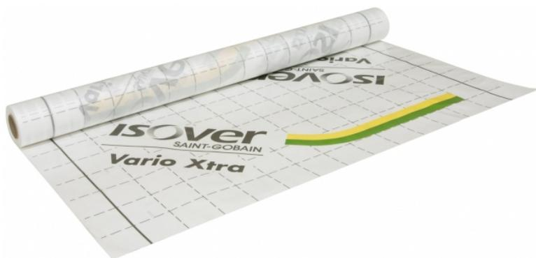
Membrane de gestion de la vapeur d'eau et d'étanchéité à l'air hygro-régulante avec une plage de sd étendue de 0,4 m à 25 m
