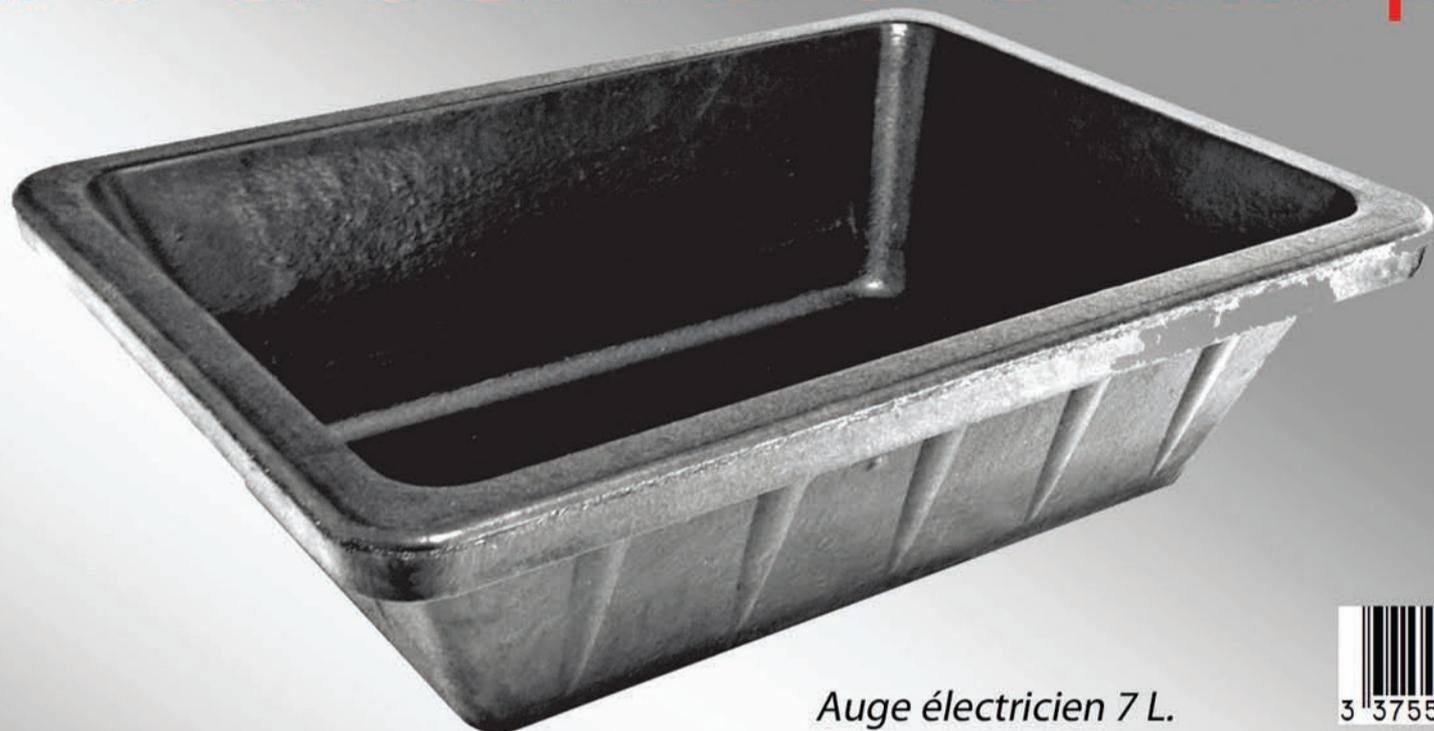
En caoutchouc naturel armé de fibres textiles à base de polyester, polyamide et rayonne. Moulage par compression, vulcanisation à 150°. (seul fabricant français)
