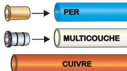
Si vous utilisez des tubes PER ou MULTICOUCHE vous devez mettre en place l'insert adapté avant la connexion.
