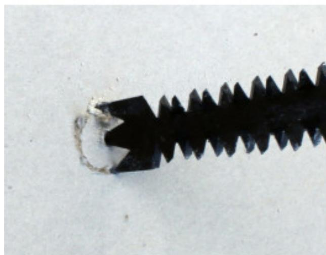
Pour réalisation des découpes en pleine plaque de plâtre, béton cellulaire, panneaux bois, etc...
