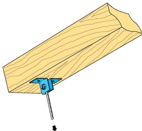
Accessoire de suspension articulé pour plafond en plaques de plâtre Placostil® F 530 sous plancher bois ou béton
