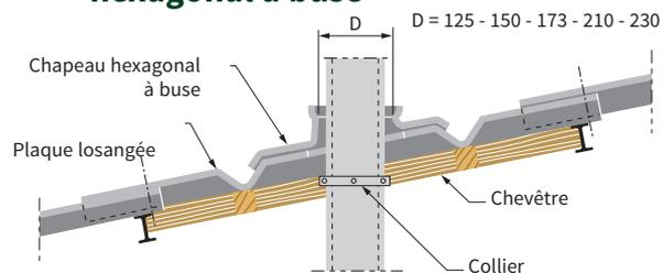
Lorsqu'elles sont traversées par un tuyau, la plaque châssis et la plaque losangée doivent être supportées par un chevêtre qui sert également à la fixation du tuyau.
