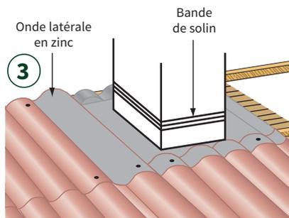
Façonner, poser et souder l'onde latérale en zinc, et engraver la bande de solin.
