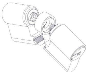
Avec le système de casse programmée (**Pre-Snap** ou **Anti-Snap**) ABUS, le cylindre casse au niveau du point de rupture. La vis du cylindre reste fermement fixé avec la serrure à encastrer. Le Panneton et l'embrayage restent intacts.
