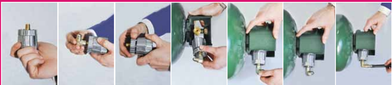
Exemple d'un montage de raccord/adaptateur pour bouteille Propane carburation
