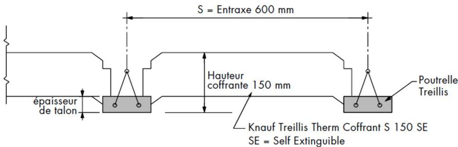
• **Knauf Treillis Therm Coffrant S 150 en position inversée**
