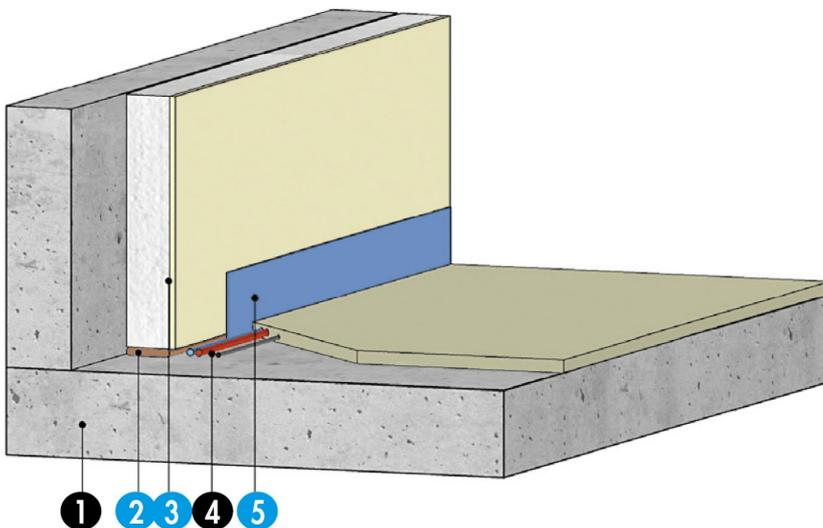
Knauf Périmousse avant mise en oeuvre sous chape hydraulique, mortier de pose ou plancher chauffant/rayonnant
